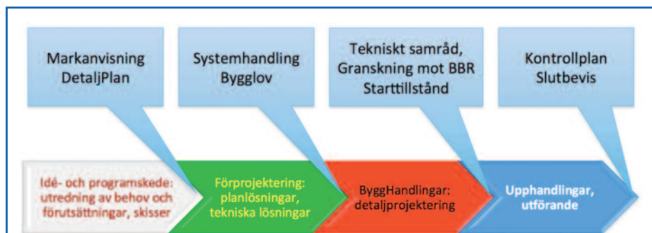
Figur 2: Byggprocessens olika skeden, schematiskt illustrerade. Intresset för en innovativ byggprodukt kan bero mycket på vilket skede av ett projekt "kunden" befinner sig i. Drifts- och förvaltningskedet har inte tagits med i modellen, men kan också påverka intresset för en innovativ byggprodukt.
